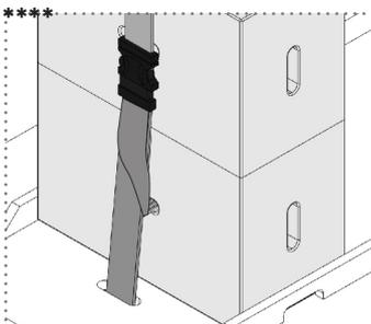
Verstauen von X-belt im Xbrick Griffloch oder zwischen X-belt und Xbrick
