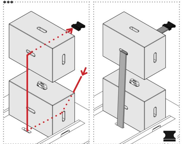
Korrektes einfädeln X-belt. Das lose Ende außen.
