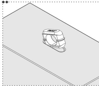
X-connector einseitig ansetzen und mit leichtem Druck einstecken
