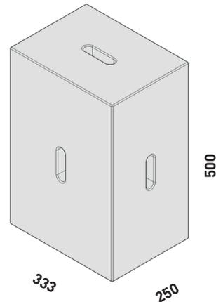
Material- und fertigungsbedingt ist es möglich, dass die Flächen Deines Xbrick nicht 100% planparallel sind und die Maße von den angegebenen Maßen um bis zu 2mm abweichen.
